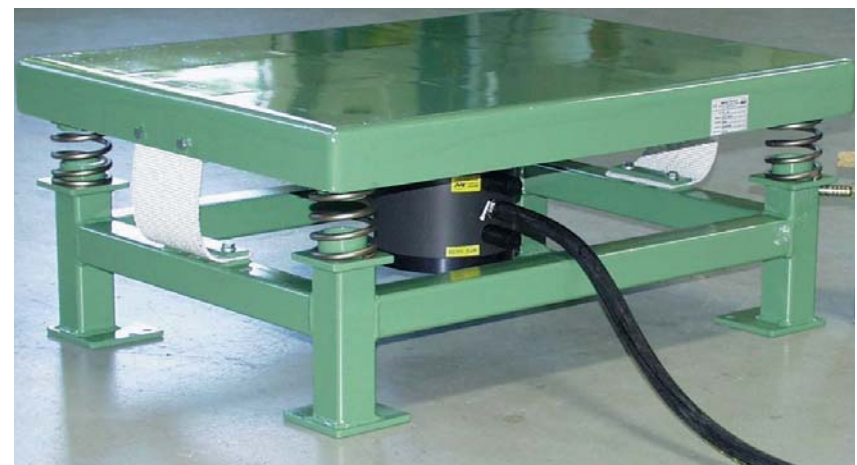
Zagęszczanie proszków w workach
