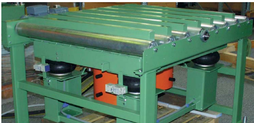
Zagęszczanie piasku formierskiego w formach odlewniczych
