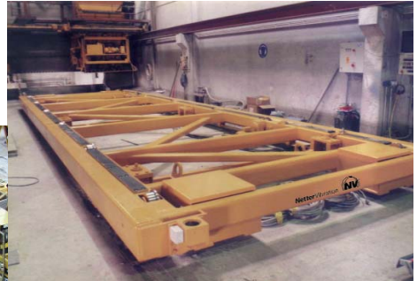
Compactage silencieux d'éléments préfabriqués avec la table vibrante de la série GyroShake ®
