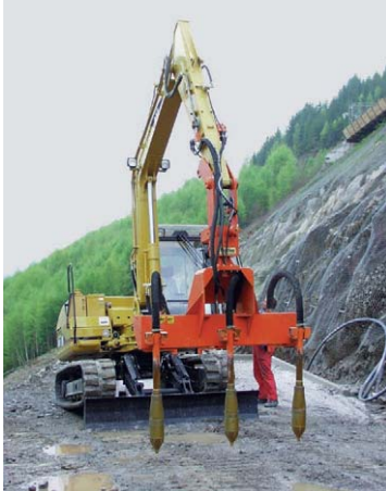
Koparka wyposażona w wibratory hydrauliczne, pogrążalne z serii NHR, przeznaczone do zagęszczania betonu
