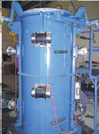
Wibratory elektryczne, przyczepne z serii NEG na formie do produkcji rur betonowych
