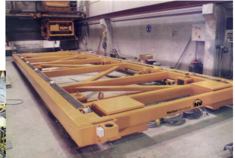
Ciche wibrowanie prefabrykatów betonowych za pomocą stołu wibracyjnego z serii GyroShake
