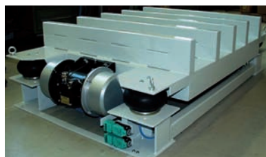
VTF/R 10/12 con 2 x NEG 251370 E, en aplicaciones conforme a la normativa ATEX
