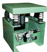
VTP 3/3 con accionamiento neumático NTS 350NF
