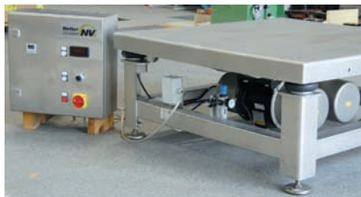
SRF y mesa vibratoria construidos en acero inoxidable
