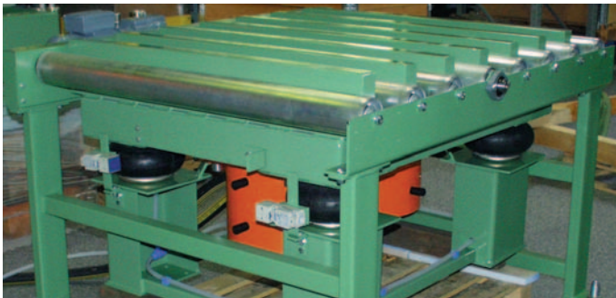
Compactación de arenas de fundición
