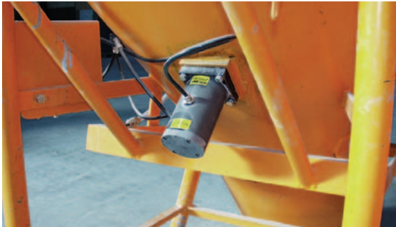
Ayuda a la descarga en contenedores
