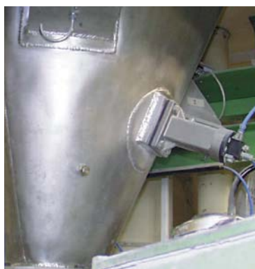
Czyszczenie ścianki zbiornika
