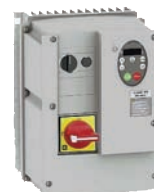
Przemienneńniki częstotliwości NFU montowane są w obudowie IP 54 przeznaczonej do montażu ściennego. Wyposażone są w wyłącznik główny, przełącznik kierunku obrotów oraz w potencjometr do ustawiania częstotliwości.
