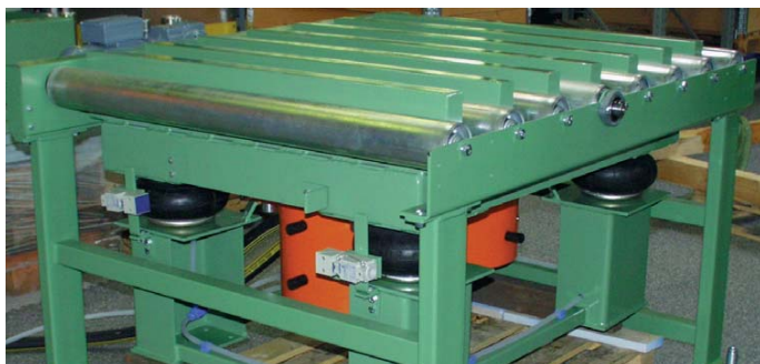
Zagęszczanie piasku formierskiego w formach odlwniczych
