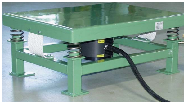
Zagęszczanie proszków w workach
