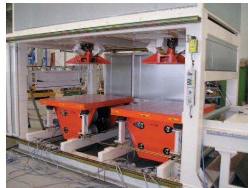
Vieillissement optique de pavés
