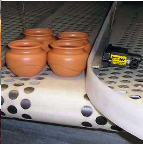
Prévention des engorgements au moyen de vibrateurs pneumatiques circulaires
