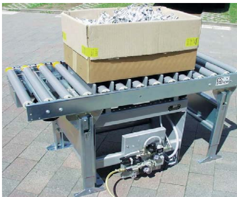
Compactage/aplanissement de matériaux au sein de la chaîne de production à l'aide d'une table vibrante
