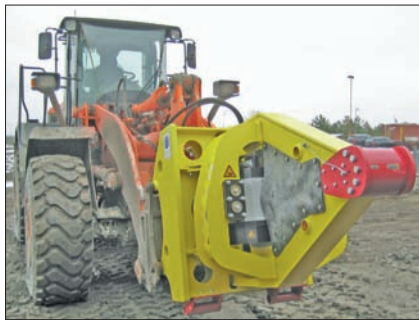
Chargeuse sur roues avec unité de vibration NHW
