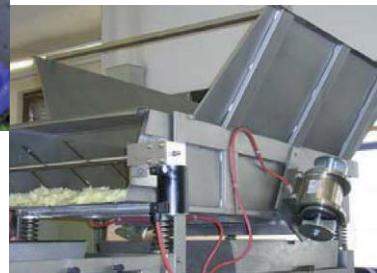
Transport au moyen de vibrateurs électriques externes en inox
