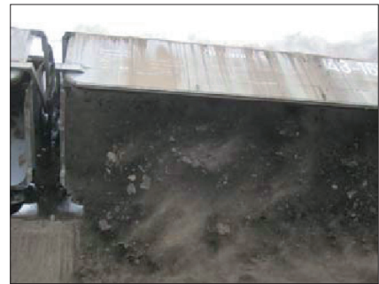
Décolmatage de cendre adhérente
