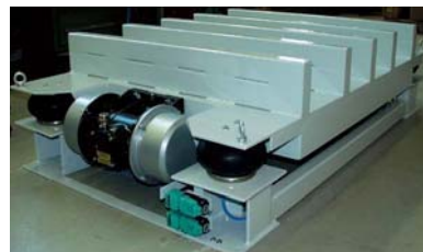
VTF/R 10/12 avec 2 NEG 251370 E pour utilisation conforme à ATEX
