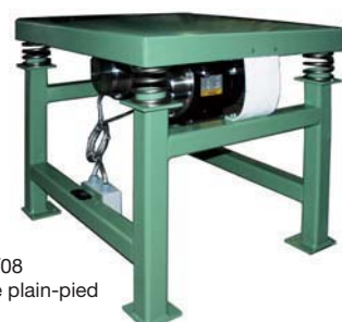
VT 7/8 avec 2 NEG 50770 electrique
