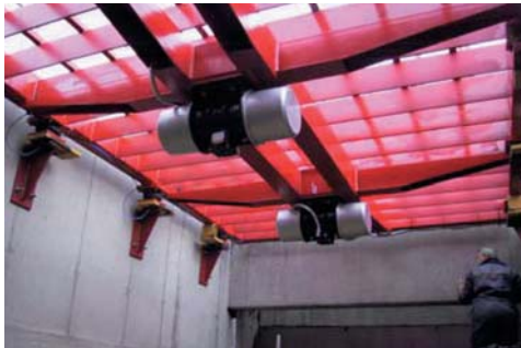
Tamisage de matières en vrac à gros grains au moyen de vibrateurs électriques externes
