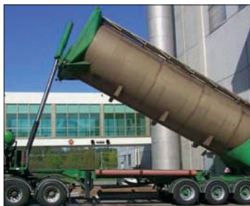
Vaciado de cubas y contenedores en vehículos
