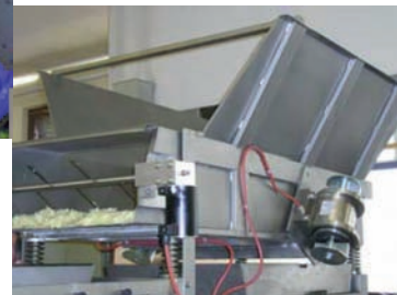
Transportes vibrantes accionados mediante vibradores rotativos en acero inoxidable
