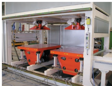
Aplicación en el envejecimiento de adoquines
