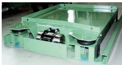
VTH/W 12/12 con 2 x NEG 501510 en una máquina de pesaje
