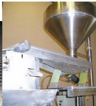
Transporte y dosificación controlada de materiales a granel con bandejas vibrantes
