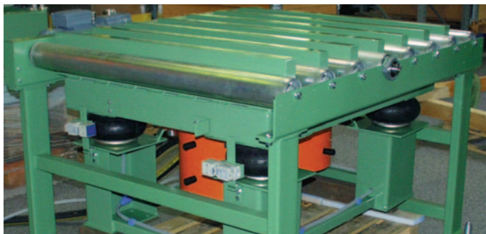
Compactación de arenas de fundición
