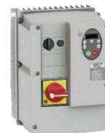
Los convertidores de frecuencia NFU con salida para motor, poseen una carcasa con protección IP54, para su montaje en fondo panel, e incluyen un conmutador on/off, control de dirección y potenciómetro de regulación
