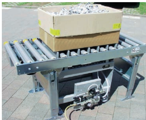
Mesas de compactación y nivelación de materiales diseñadas para proceso en continuo
