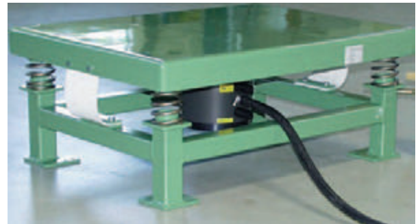
Verdichten von Pulver in Säcken
