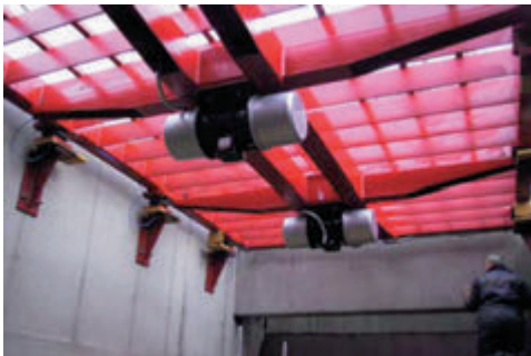
Sieben von grobem Schüttgut mit Elektro-Außenvibratoren
