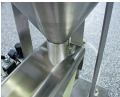
Dosierstutzen am Behälteraustausch
