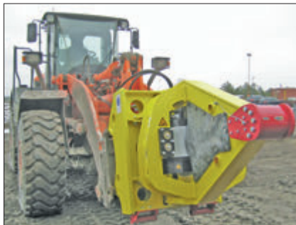
Radlader mit Vibrationseinheit NHW
