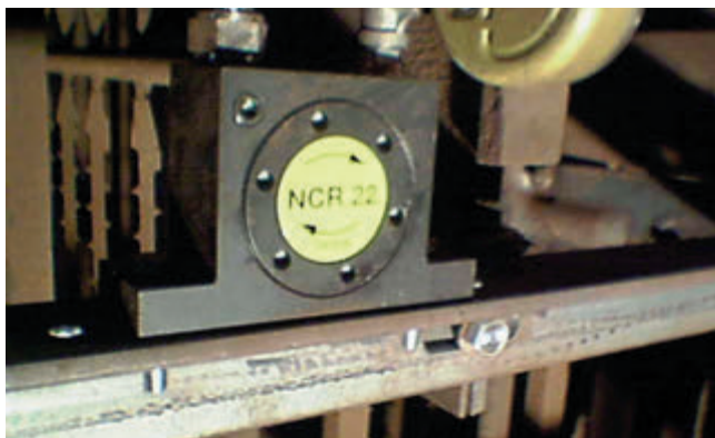
Abreinigen von Filterdrähten
