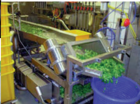
Fördersiebrinne, angetrieben mit Edelstahl-Elektro-Außenvibratoren
