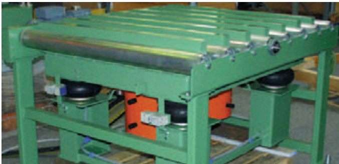
Verdichten von Formsand in Gießereiformen
