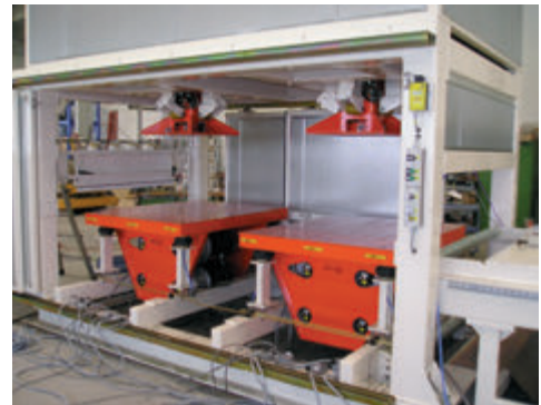
Optisches Altern von Pflastersteinen
