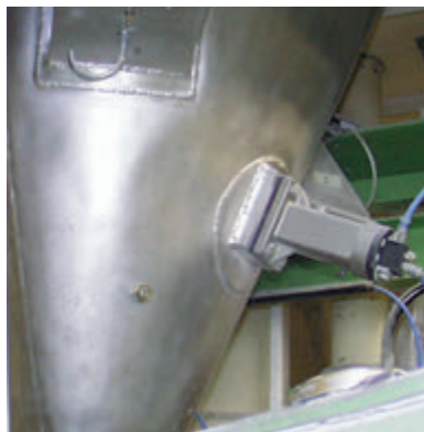
Abreinigen von Bunkerwänden
