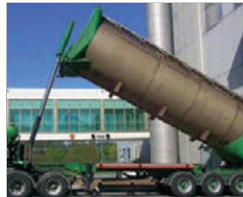
Entleeren von Silofahrzeugen
