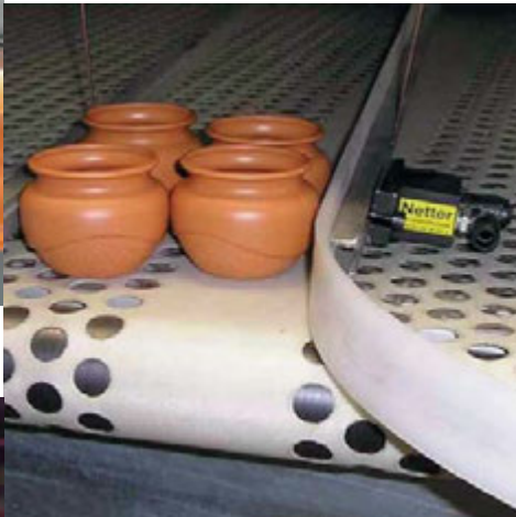
Vermeiden von Produktstaus mit Druckluft-Kreisschwingern
