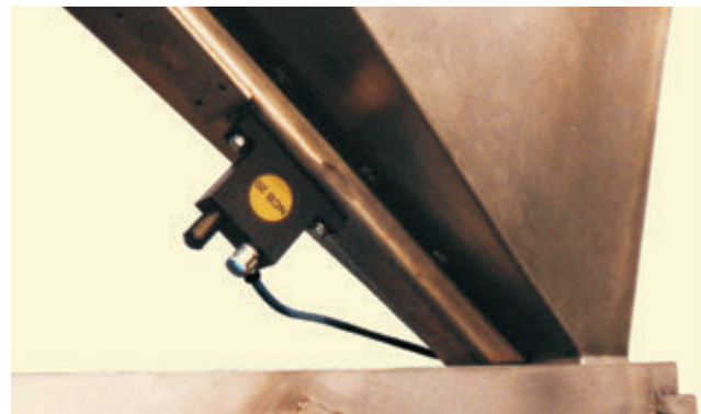
Entleeren ohne Brückenbildung
