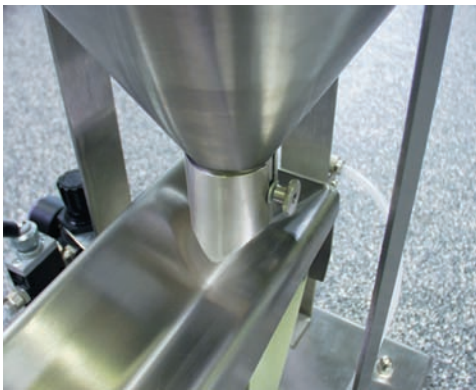
Dispositivo para control de flujo a la salida del tolvin
