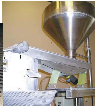
Точное подавание и дозирование сыпучих материалов при помощи вибрационного подавателя
