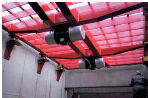
Просеивание крупнозернистых материалов при помощи электрических вибраторов
