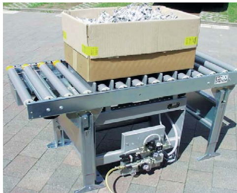
Загущение / распределение материалов на производственной линии при помощи вибрационного стола
