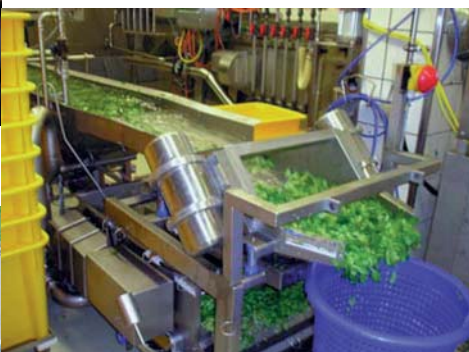
Подаватель, с ситом приводимый в действие электрическими вибраторами из нержавеющей стали
