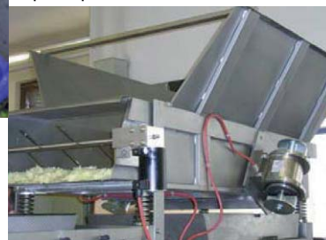
Подаватель из нержавеющей стали оснащенный электрическими вибраторами
