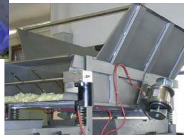
Podajnik wyposażony w wibratory elektryczne wykonane ze stali nierdzewnej
