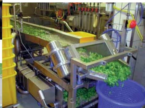
Podajnik z sitem napędzany wibratorem elektrycznym wykonanym ze stali nierdzewnej
