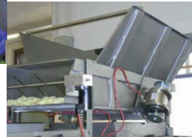
Transportes vibrantes accionados mediante vibradores rotativos en acero inoxidable
