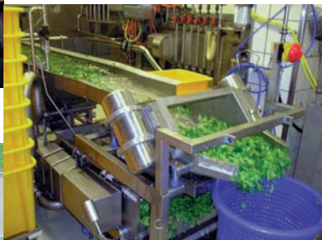
Transporte con tamizado, accionado mediante vibradores eléctricos en acero inoxidable
