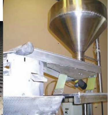
Transporte y dosificación controlada de materiales a granel con bandejas vibrantes
