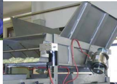
Fördern mit Edelstahl-Elektro- Außenvibratoren
