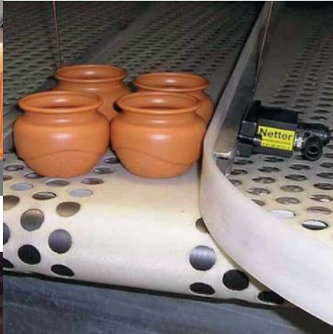
Vermeiden von Produktstaus mit Druckluft-Kreisschwingern
