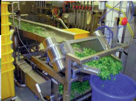
Fördersiebrinne, angetrieben mit Edelstahl-Elektro-Außenvibratoren
