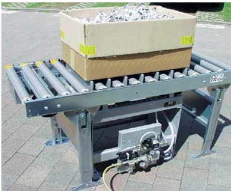
Verdichten/Einebnen von Material innerhalb der Produktionslinie mit einem Vibrationstisch
