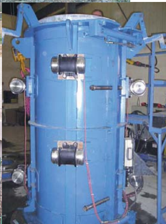
Прицепные, электрические вибраторы серии NEG на форме, для производства бетонных труб.
