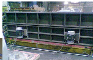
Загущение бетона в стальной форме, при помощи прицепных электрических вибраторов серии NEG.
