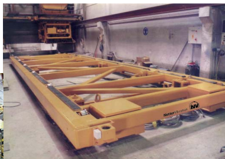
Тихое вибрирование изделий из бетона, при помощи вибрационного стола серии GyroShake®.
