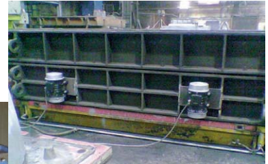
Compactage de béton sur un coffrage en acier avec vibrateurs électriques externes de la série NEG
