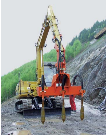
Pelleteuse équipée de vibrateurs pneumatiques internes de la série NHR pour le compactage de béton de masse
