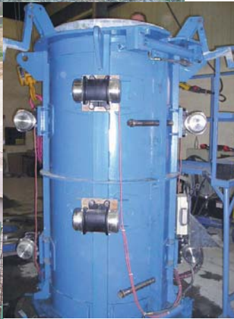
Vibrateurs électriques externes de la série NEG sur un moule de tuyau en béton
