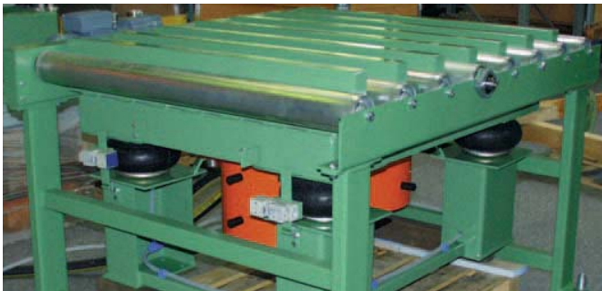
Verdichten von Formsand in Gießereiformen
